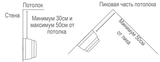
Минимум один датчик на этаж и максимальной дистанцией 10 метров между датчиками.
